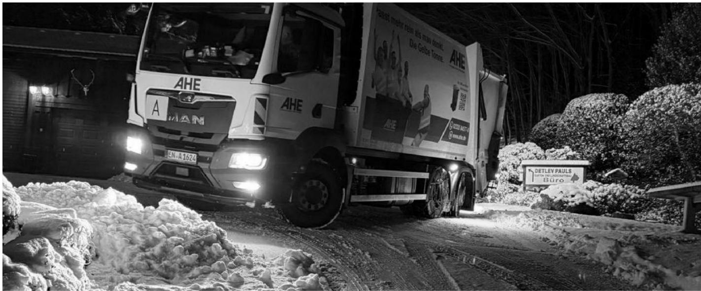
Bis zu 25 Tonnen wiegt ein komplett befülltes Müllfahrzeug der AHE, die samt und sonders mit Schneeketten ausgestattet sind.
